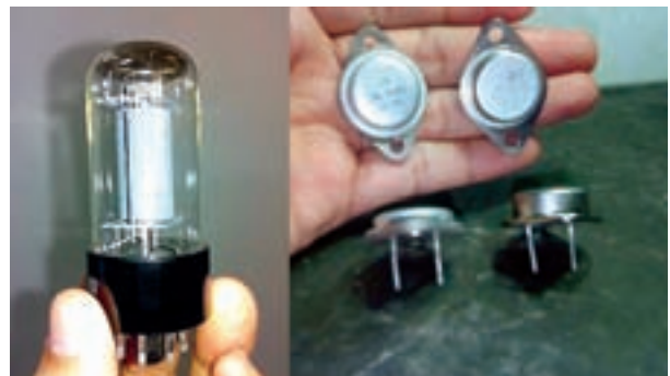
شکل ۲-۵ مقایسه‌ی شکل ظاهری ترانزیستور و لامپ
