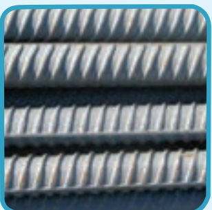
شکل ۱۷-۱- میلگرد با رویه آجدار
