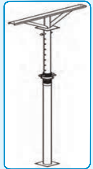
شکل ۲۲-۳- شمع فلزی کامل تنظیم ارتفاع
